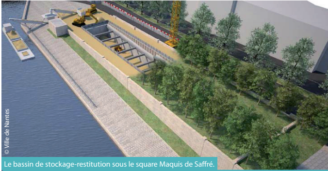
Le bassin de stockage-restitution sous le square Maquis de Saffré.
