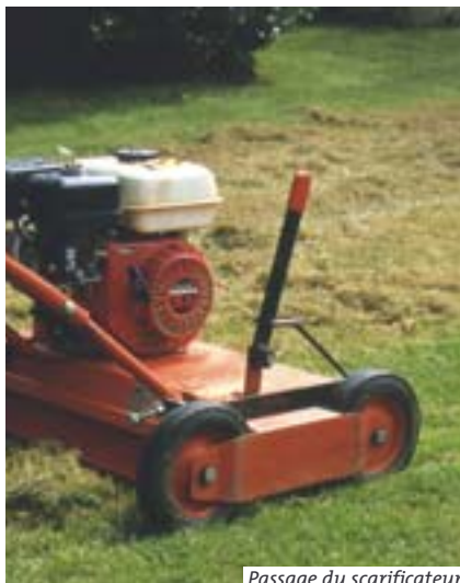
Passage du scarificateur
