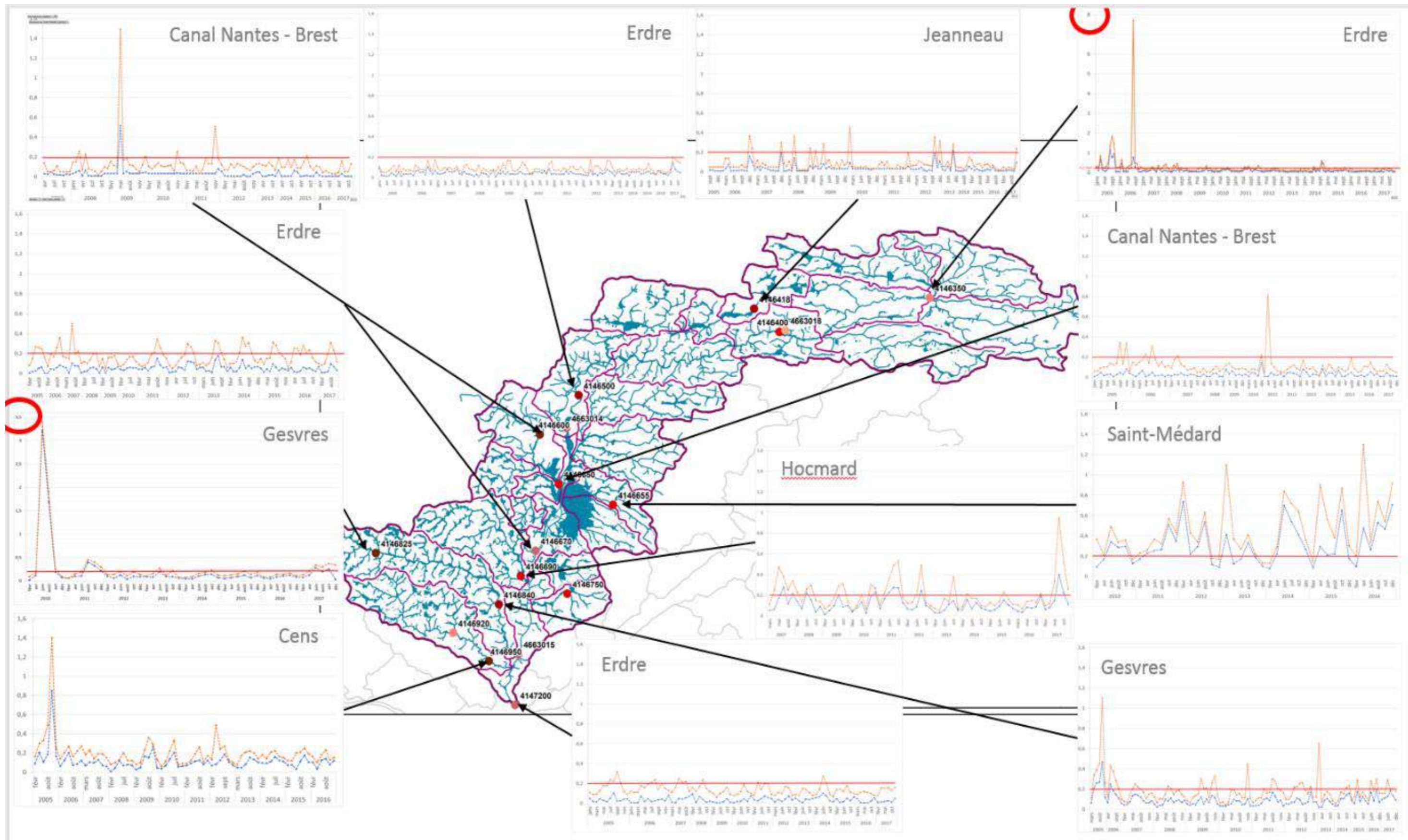
Figure 77: Evolution spatio-temporelle des concentrations en phosphore total et en ortho-phosphates sur le bassin versant de l'Erdre
